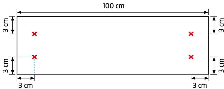
**X** Bohrung Altholzbretter mit 4 mm Holzbohrer
