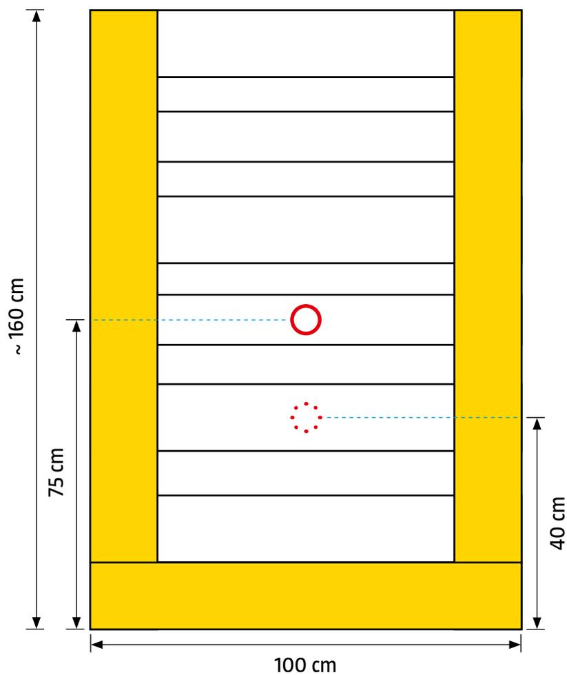
**⊙** Bohrung mit Forstnerbohrer 35 mm
