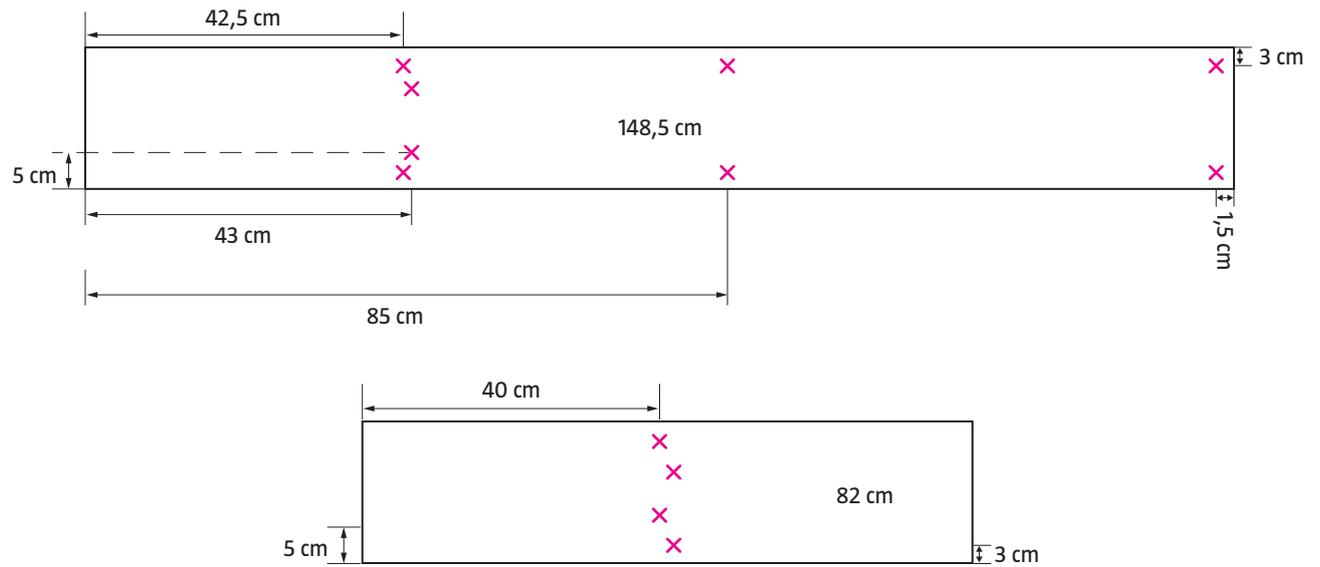
Alle Bohrungen mit 8 mm Holzbohrer senkrecht zum Unteren Brett.
