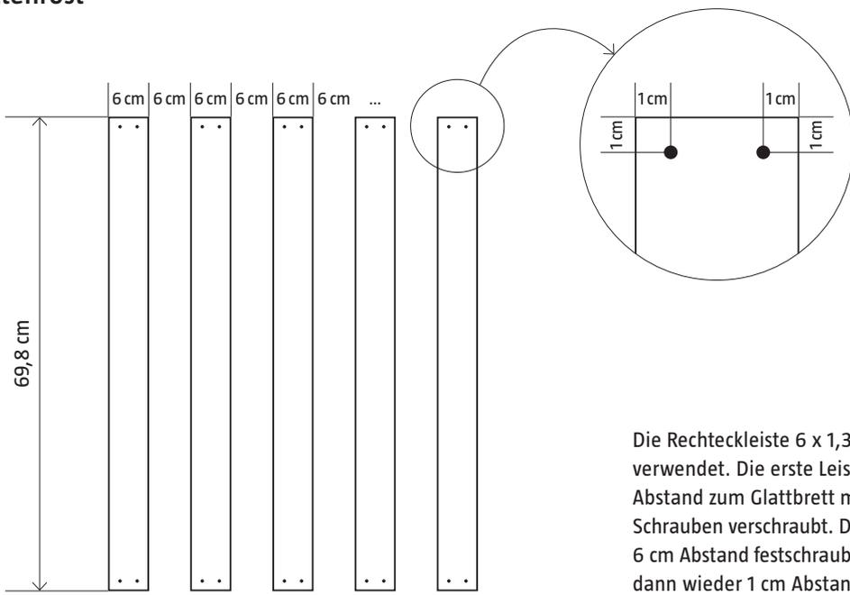
Die Rechteckleiste 6 x 1,3 cm wird 12 mal verwendet. Die erste Leiste wird mit 1 cm Abstand zum Glattbrett mit 3 x 20 mm Schrauben verschraubt. Die nächste Leiste mit 6 cm Abstand festschrauben. 12 x wiederholen, dann wieder 1 cm Abstand halten.
