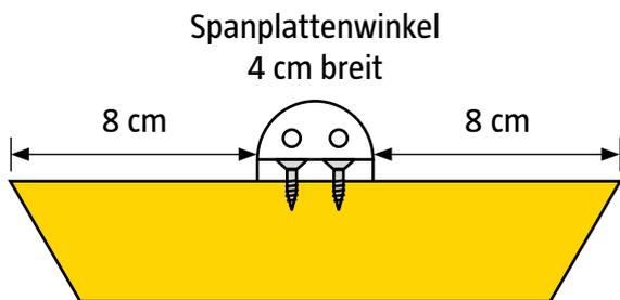
**✗** Bohrpunkte für 2,4 mm Holzbohrer und Kegelsenker für Verschraubung mit 3 x 16 mm Schrauben
