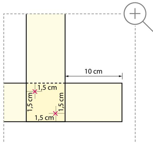
✕ Markierung für Bohrung  $\varnothing$  6 mm für 6 x 100 mm Edelstahrschrauben
