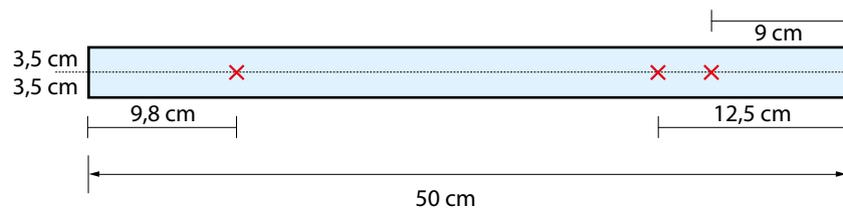
✗ Markierung für Bohrung  $\varnothing$  14 mm für Edelstahlgewindestange 12 mm
